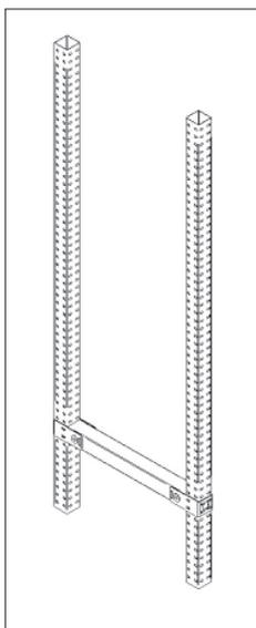
**SPALLA 32/1** - portata 1100 daN con interasse livelli max 400mm
